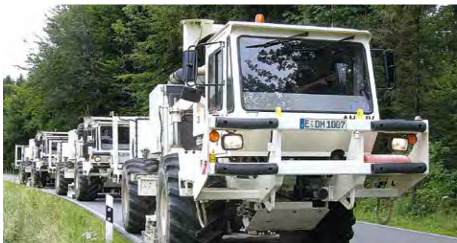
Konvoi: Die wuchtigen Vibro-Trucks rollen mit vier bis fünf Tageskilometern durch die Straßen.
